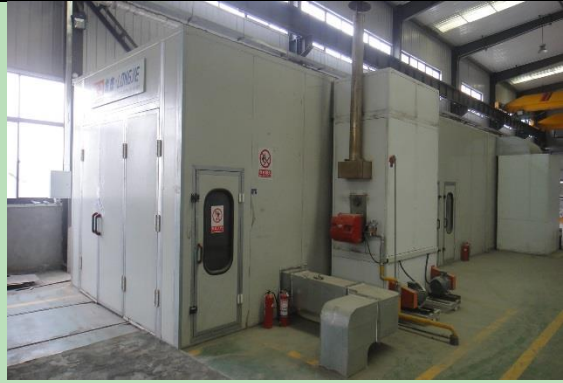
封闭式喷漆房、烘干房
