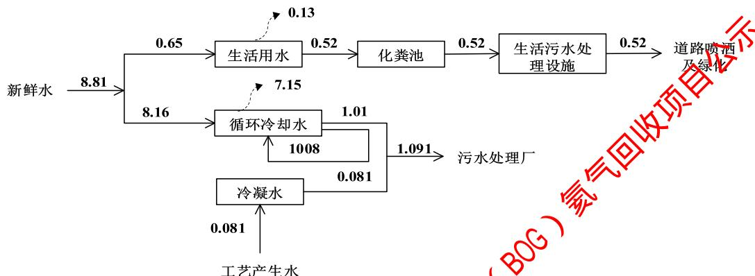
图 2-1 本项目水平衡图 (单位:  $m^3/d$ )
